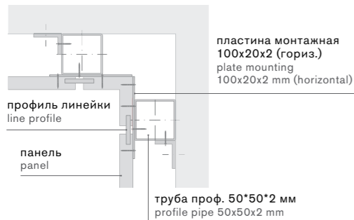
Узел крепления стыка двух панелей внутренний угол под 90° через линейку, стык 10 мм. Node fixing joint between two panels with internal angle of 90° through the line, the joint is 10 mm.
