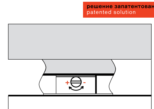
H Регулировочный винт (регулировка 0+8 мм) Adjust screw (adjustment of 0+8 mm)
