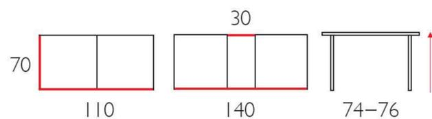
**Столешница:** Пластик. Толщина 23 мм (22 мм ЛДСП + 1 мм пластик HPL)
