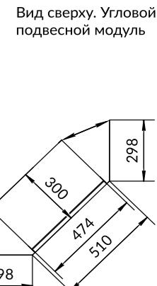
Глубина стационарного модуля со столешницей: 550 мм., без столешницы 448 мм.
