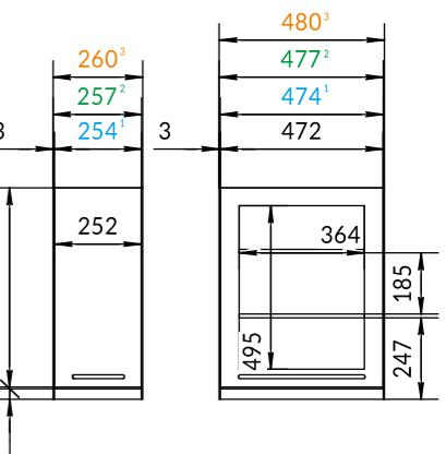
Глубина стационарного модуля со столешницей: 550 мм., без столешницы 440 мм. Глубина настенных модулей 338 мм.
