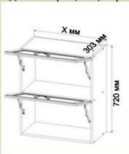
В горизонтальных шкафах в качестве подъемного механизма используется механический кронштейн. Кронштейн имеет регулировку жесткости хода. Фасад крепится к корпусу сверху с помощью 2-х накладных петель.
