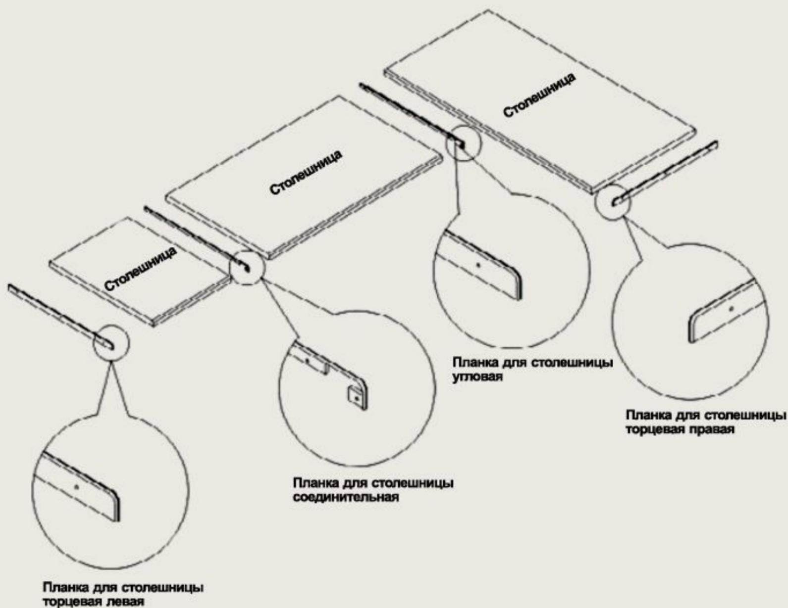
Алюминиевые планки для стыковки и закрытия торцов столешниц
