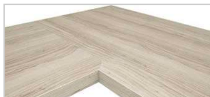
Соединение столешниц – еврозапил. В местах соединений – 3 стяжки и 2 плоских шканта
