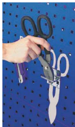
Вертикальное размещение инструмента с применением метода теней.
