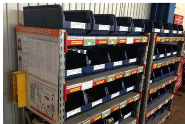
Сортировка предметов по пластиковой таре и ярусам хранения на стеллажах с маркировкой предметов и мест хранения.
