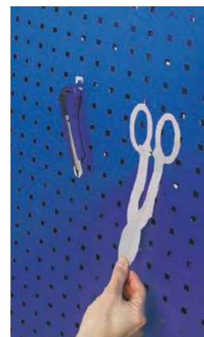
Вертикальное размещение инструмента с применением метода теней.
