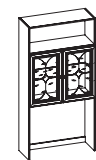
Средняя секция МКС 144-21-1 (стеклянная полка и зеркало); 900x371x1804 (высота ниши 714); вес 49,4кг; V=0,14м 3
